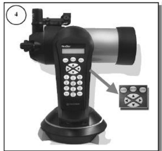
Une fois mis en marche, l'affichage indiquera *Nexstar Ready* Presser *ENTER* pour auto-aligner le Nexstar. L'affichage de la raquette de commande vous demandera de bouger le tube du télescope pour le mettre à niveau et face à l'horizon nord. Utiliser les touches de défilement Haut et Bas pour le positionner en direction du Nord
