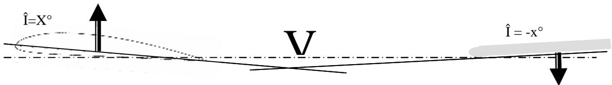
Compte tenu des profils utilisés sur les avions de début et d'empennages dont le plan horizontal est souvent constitué d'une simple plaque, le V longitudinal est généralement obtenu en reposant l'aile sur le fuselage par son intrados et en alignant le plan horizontal avec l'axe du fuselage. Cette disposition simplifie la construction.
